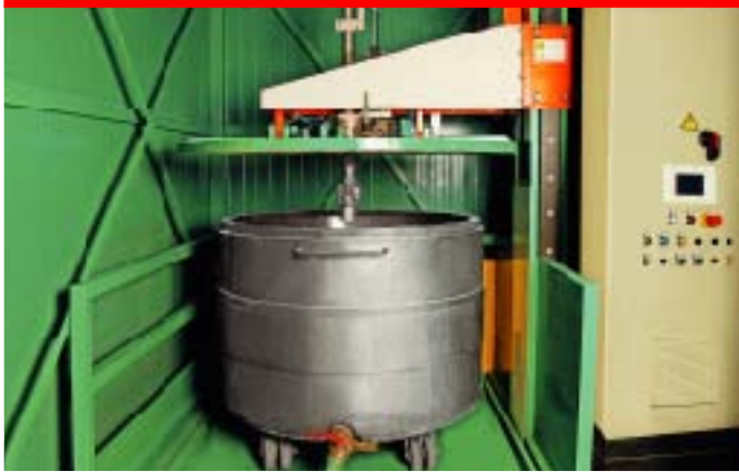
现使用高压水取代溶剂对意大利 Cerano 生产基地的混合容器进行清洁。
