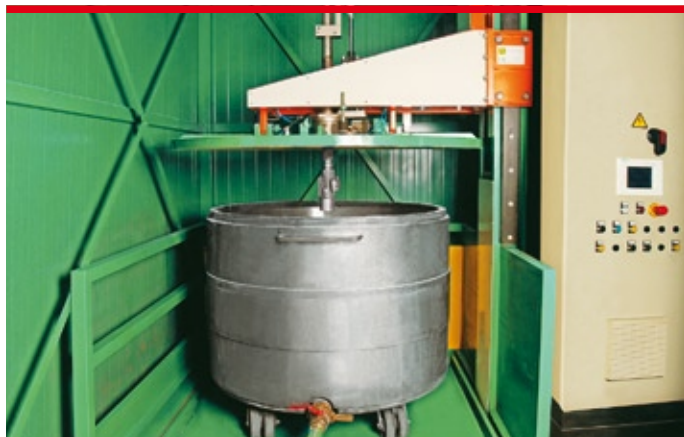
Die Mischkessel im Werk Cerano in Italien werden nicht mehr mit Lösemitteln, sondern unter Hochdruck mit Wasser gereinigt.
