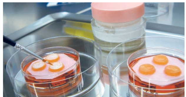
Tierversuchsfreie Prüfmethode: Auf dieses von Henkel entwickelte Vollhautmodell können Substanzen aufgetragen und so deren Wirkung auf das Hautgewebe systematisch bewertet werden.
