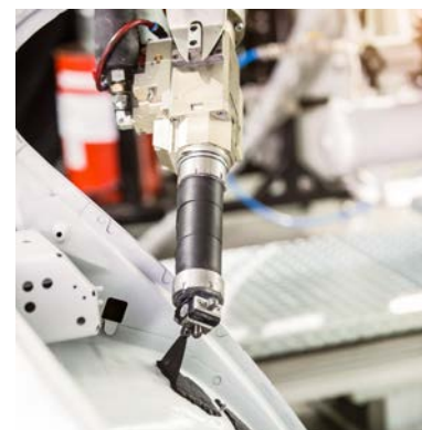
Gewichtssparend, sauber und effizient: automatisierter Auftrag spritzbarer Schalldämpfungsmassen (LASD).
